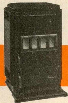
223. FAURE. Calorifère « GROENLAND » tout fonte. Grande puissance de chauffe. Très haut rendement. Foyer à récupération de chaleur par circulation activée des gaz tout autour du corps de l'appareil. Feu visible. Grande facilité de réglage. Chargement en façade. Polycombustible. Vol. de chauffe 320 m 2 ; haut. totale 880; larg. 530.
