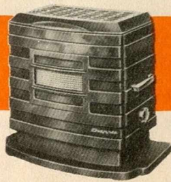
215. CHAPPÉE. Poêle à bois «8008» à feu continu, à feu visible. Enveloppe en fonte émaillée chamois. Coffre de combustion en acier. Plateau de chargement étanche avec mentonnet. Permet l'utilisation de bûches de 40 cm. Plateau de parquet sur demande. Vol. de chauffe de 80 à 120 m 2 ; haut. totale 525; larg. 500.
