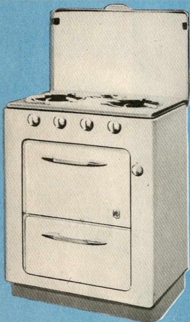
63. FAR . Cuisinière « FLOREAL ». Tout acier émaillé blanc. Table de travail ouvrante à 3 brûleurs. Grilles amovibles émaillées. Dossier émaillé. Four de grandes dimensions à triple parois à circulation, calorifuge « Roclaïne ». Régulation de four par thermostat, breveté S.G.D.G. Etuve-tiroir au dessous du four. EST NF-ATG. Adaptable à tous les gaz, par injecteurs interchangeables. Larg. 620. - Prof. 410. - Haut. 800.
